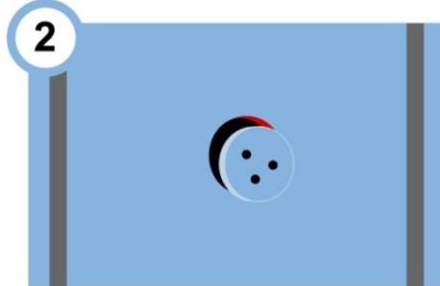
2 Inserte un parche de panel de yeso en la perforación del sistema de ASF ME
