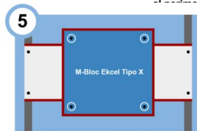
5 Centre una pieza de 12" x 12" mínimo de tablero de pared M-Bloc Ekcel tipo X de 1/2" y asegure con tornillos de laminación tipo G de 1 1/2" en cada esquina. Una vez en su lugar, aplique masilla ignífuga en el perímetro (repita todos los pasos en el lado opuesto de la pared)
